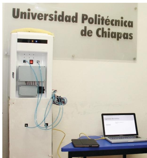
tiempo transcurrido de la terapia y por seguridad cuenta con un paro de emergencia. Consiste en aplicar frío-calor de manera automatizada en partes específicas del cuerpo principalmente para inflamaciones crónicas, dolores articulares, golpes, entre otras, a fin de atender las
